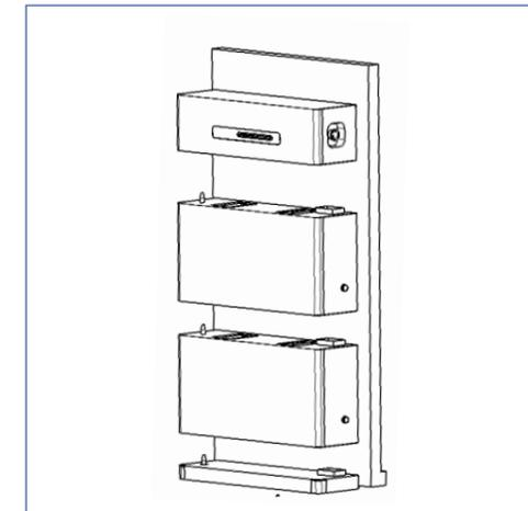
2.5 Schrauben Sie die Befestigungsbolzen ein.
